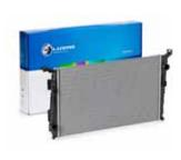
пания LUZAR наладила выпуск радиатора охлаждения для модификаций с двигателем 1.5dCi. Среди особенностей изделия можно отметить трубчато-ленточную несборную алюминиевую конструкцию, изготовленную по технологии «Ноколок», а также охлаждающую сердцевину увеличенной толщины (26 мм).
